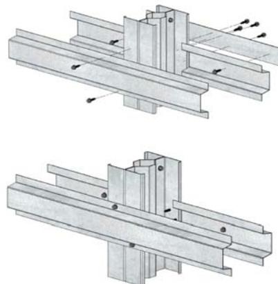
Figure 11 : Mise en œuvre du dispositif anti - déversement
