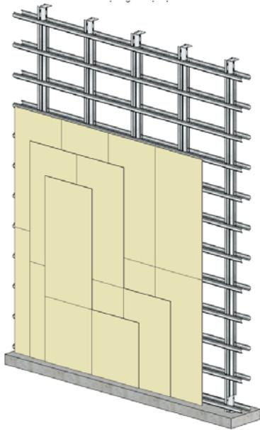
**Figure 18 : Principe calepinage des plaques – Exigence feu**
