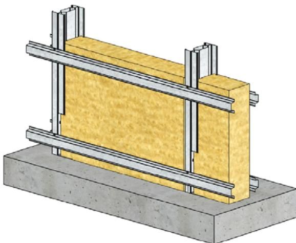
Figure 13 : Mise en œuvre de l'isolant
