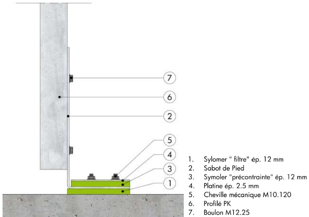
Figure 33 : Principe de traitement acoustique en pied
