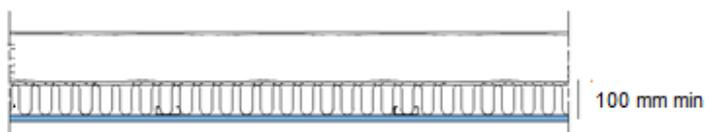
Lames d'air : cas avec isolant.
