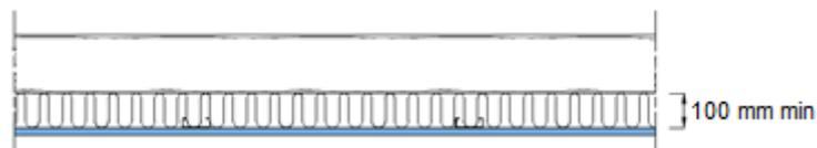
Lames d'air : cas avec isolant.
