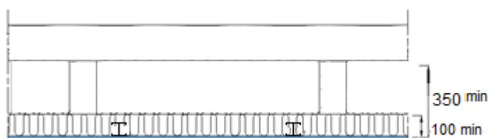
Lames d'air : cas avec isolant.
