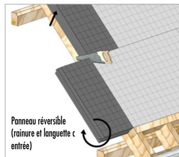
NB : les épaisseurs de Knauf Thane Sarking inférieures à 120 mm doivent être posées sur un support continu.
