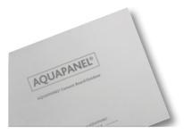
Aquapanel® Outdoor est une plaque ciment, armée sur chaque face par un treillis de fibre de verre traité contre les alcalis, particulièrement adaptée pour la réalisation de bardages, plafonds, soffites et autres applications extérieures en tant que support de finitions.
