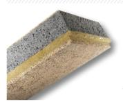
KNAUF FIBRA Panneau isolant composite de laine de bois constitué d'une âme en PSE gris, de laine de roche et de deux parements de fibres longues de bois résineux sélectionnées, minéralisées et enrobées de ciment blanc.
